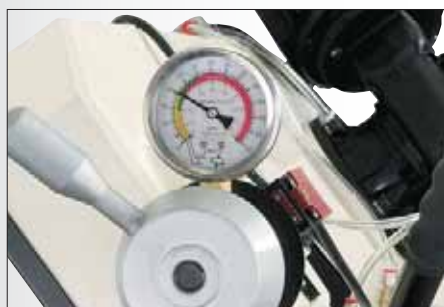
Тензометр контроля натяжения полотна
