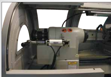
Управляемый пневматический цанговый зажим
