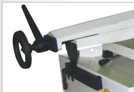
Быстрозажимная эксцентриковая рукоятка подвижной губки тисков
