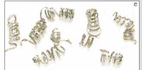
Свободно намотанная (витая) стружка - идеальные условия резания
