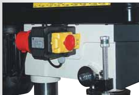
Правое и левое вращение для моделей 400 В Регулируемый упор глубины сверления
