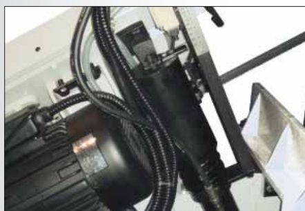
Гидроцилиндр подъема рамы с регулируемым концевым выключателем
