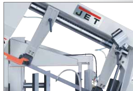
Регулируемые подшипниковые блоки опоры
