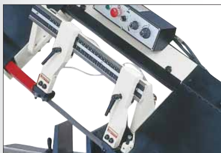
Быстроспереставляемые опоры подшипниковых узлов
