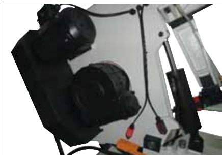
Привод и гидроцилиндр с концевыми выключателями
