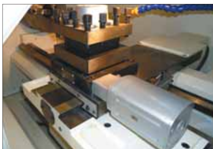
4-х позиционный резцедержатель с автоматической сменой инструмента
