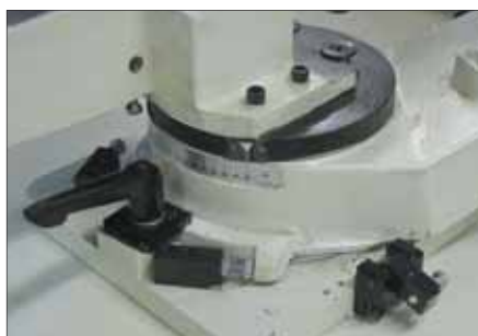
Регулируемые упоры углов положения пильной рамы
