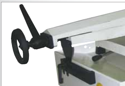
Быстрозажимная эксцентриковая рукоятка подвижной губки тисков
