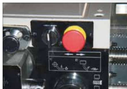
Ускоренное продольное перемещение суппорта, 5 м/мин (для моделей с RFS)
