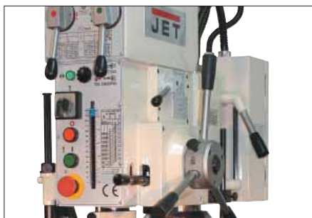
Рукоятки управления и фиксации сверлильной головки
