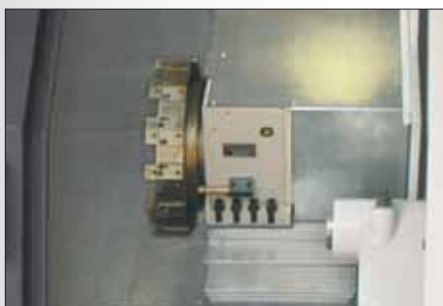
Револьверная голова и гидравлическая пиноль задней бабки
