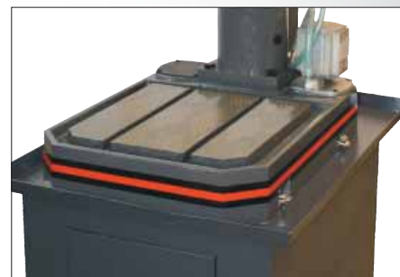
Стол со встроенной системой подвода СОЖ
