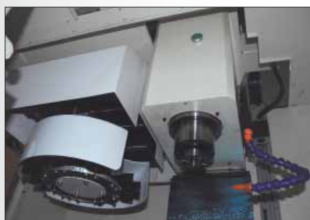
8-позиционный инструментальный магазин с механизмом смены инструмента
