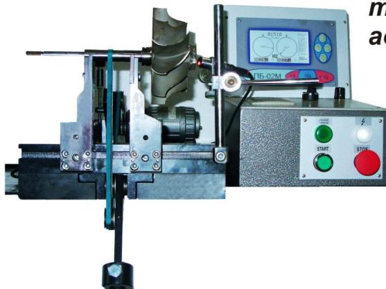
*Предназначен для балансировки роторов турбокомпрессоров легковых и грузовых автомобилей, а также сельхозтехники*
