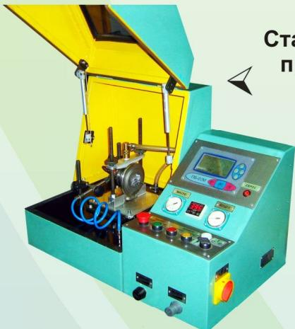
Станок добалансировочный модели ДБС-Т1 предназначен для добалансировки ротора турбокомпрессора в сборе с корпусом, а также для проверки утечки масла.
