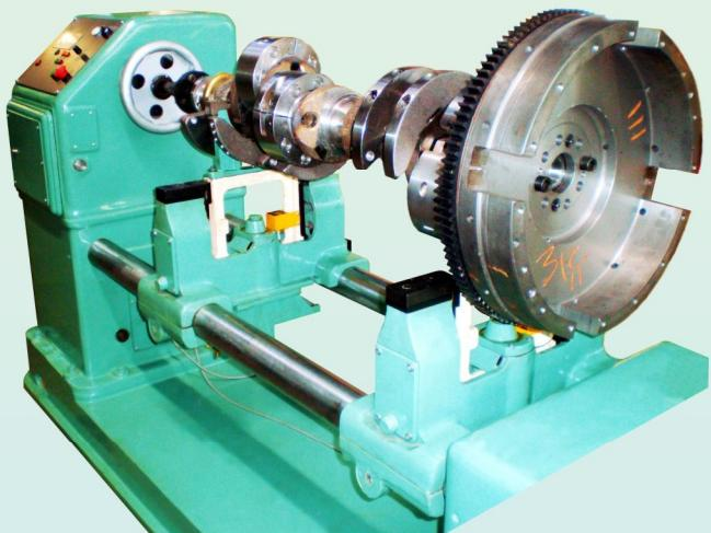
Станок балансировочный модели КИ-42-74 предназначен для балансировки коленчатых валов массой от 5 до 150 кг.
