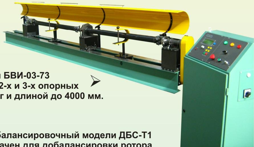
Станок балансировочный модели БВИ-03-73 предназначен для балансировки 2-х и 3-х опорных карданных валов массой до 100 кг и длиной до 4000 мм.
