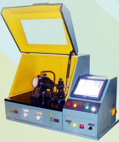
Станок балансировочный разгонный модели СБР-1 предназначен для высокоскоростной балансировки ротора турбокомпрессора на частотах вращения, достигающих максимальных эксплуатационных значений.
