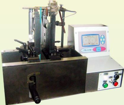
Станок балансировочный модели БВИ-03-10Т предназначен для балансировки роторов турбокомпрессоров легковых и грузовых автомобилей, а также сельхозтехники.
